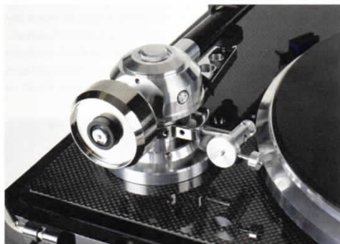
Bei EATs Antiskating-Einrichtung zieht der Tonarm waagrecht am Schaft einen Faden mit, der via Umlenkrolle ein Gewichtchen hochzieht. Das funktioniert in der Praxis hervorragend.
