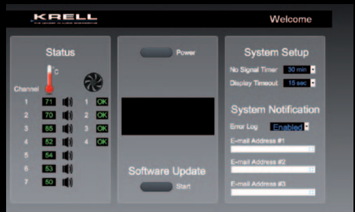
Das Online-Menü ist für Verstärker mit bis zu sieben Kanälen vorgesehen. Firmware-Updates geschehen auf Knopfdruck.
