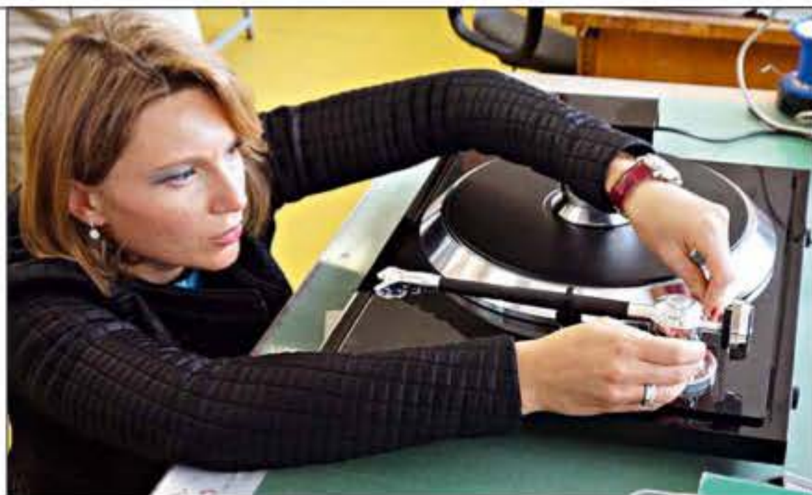
Hier legt die Chefin selbst Hand an: Jozefina Lichtenegger stellt in der Fertigung die Antiskating-Einrichtung ein
