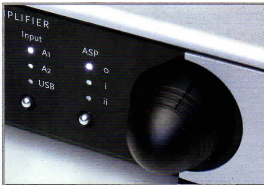
Mit ASP (Analogue Spatial Processing) versucht der Meridian Prime eine natürliche Lautsprecherwiedergabe unter Kopfhörern zu simulieren
