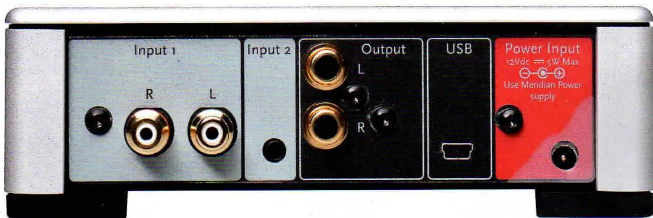
Der Meridian Prime bietet einige Anschlussmöglichkeiten, lässt aber auch etwas vermissen. Mit USB streamen wir Audiodateien bis zu 24 Bit und 192 Kilohertz von einem Computer. Mindestens einen koaxialen und ein optischen Anschluss hätten wir uns noch gewünscht
