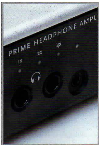
Drei Klinkenausgänge für Kopfhörer mit verschiedenen Impedanzgrößen
